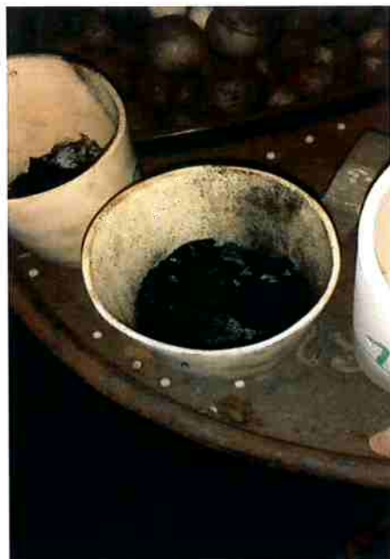
Figura 26. Cadinhos com carvão vegetal e as amostras preparadas para a carbonização.
