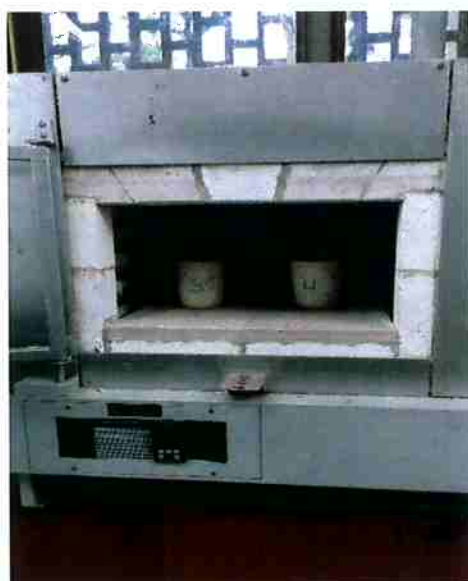
Figura 24. Amostras dentro do forno utilizado na carbonização dos resíduos alimentares.
